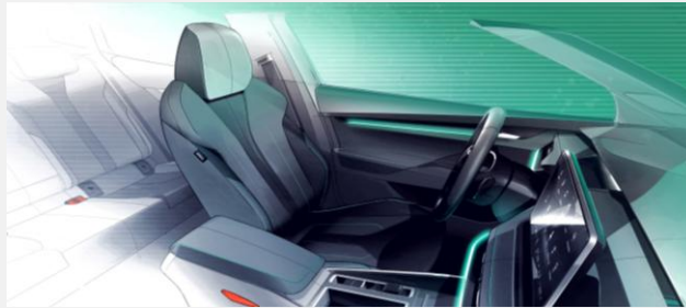
Paneles de puertas y reposabrazos central fabricados con tela RecyTitan con 78% de PET reciclado, proveniente de botellas plásticas
